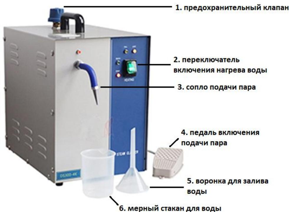
Парогенератор DS-300 – это недорогой, компактный и простой в использовании парогенератор. Он снабжен системой, которая контролирует уровень воды в бойлере, автоматически отключая нагрев при достижении минимального уровня, а звуковой сигнал информирует оператора о том, что следует залить воду в бойлер через клапан на верхней части парогенератора.
